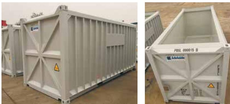
Рис. 3. Усиленные контейнеры для угля, спроектированные для многочисленных циклов выгрузки переворотом. Могут оснащаться крышками с J-образными замками (источник: Adelaide Shipping Containers Pty Ltd)
