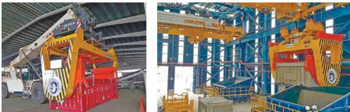
Рис. 5. Револьверный спредер фирмы RAM Spreaders для ричстакера и для мостового крана в работе
