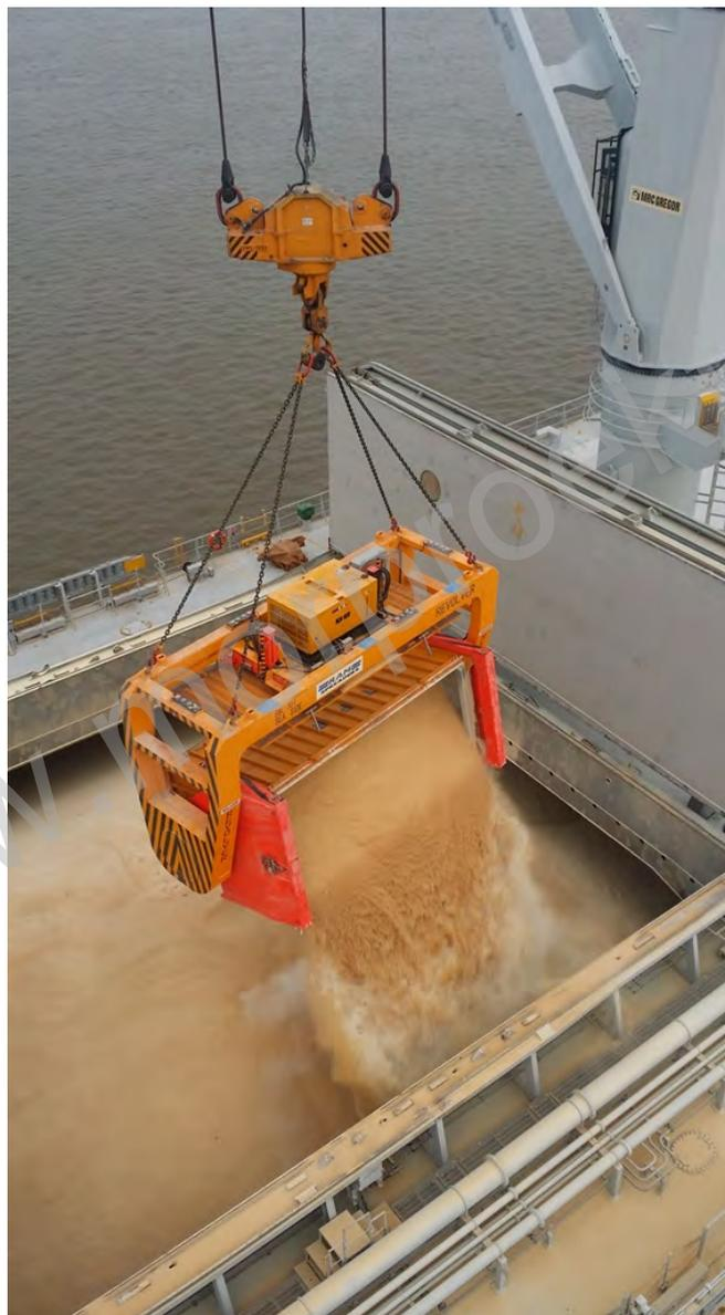
Спредер автоматически снимает верхнюю крышку контейнера, переворачивает контейнер, удерживая эту крышку. Одним из условий для нормальной работы такого спредера является требование совмещения оси вращения контейнера с центром его тяжести для ограничения воздействия крутящего момента от груза на механизм вращения спредера.
