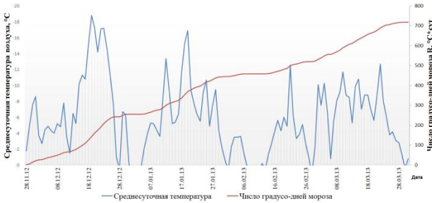
Рисунок 1: Пример взаимосвязи между среднесуточными температурами воздуха и числом градусо-дней мороза
