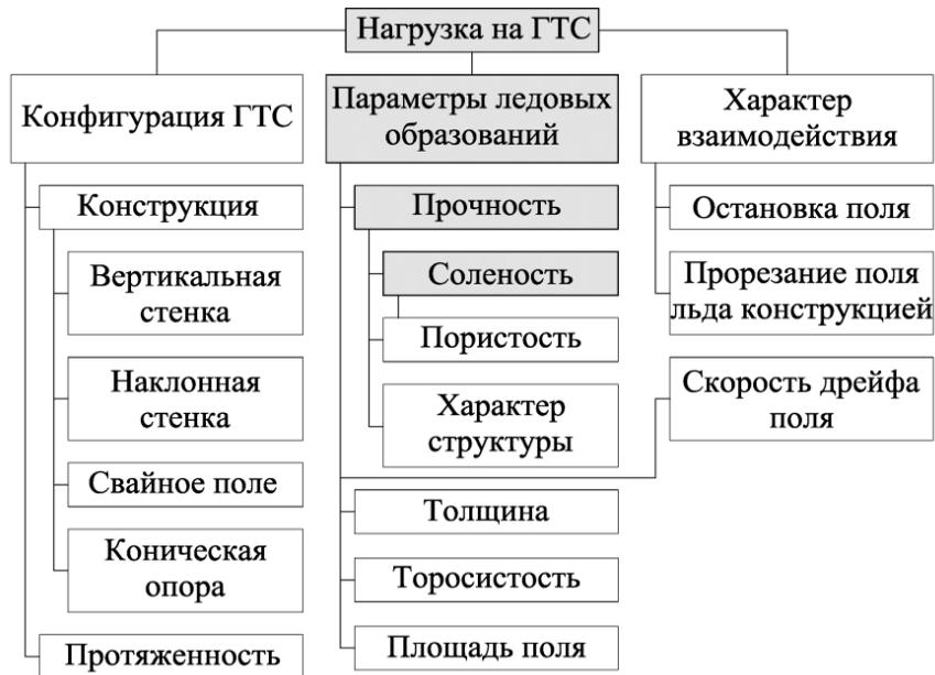
Рисунок 1: Схема факторов, обуславливающих нагрузку на ГТС
