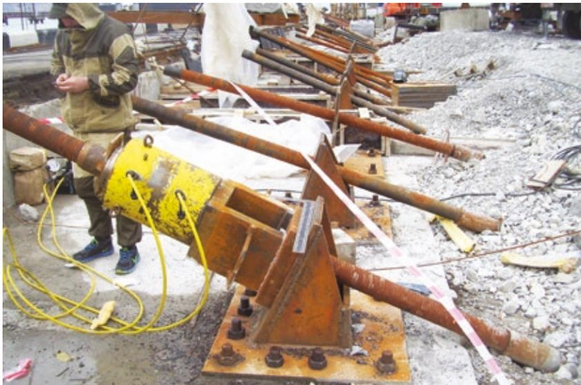
Рис. 3. Испытание анкера с использованием проходного домкрата
