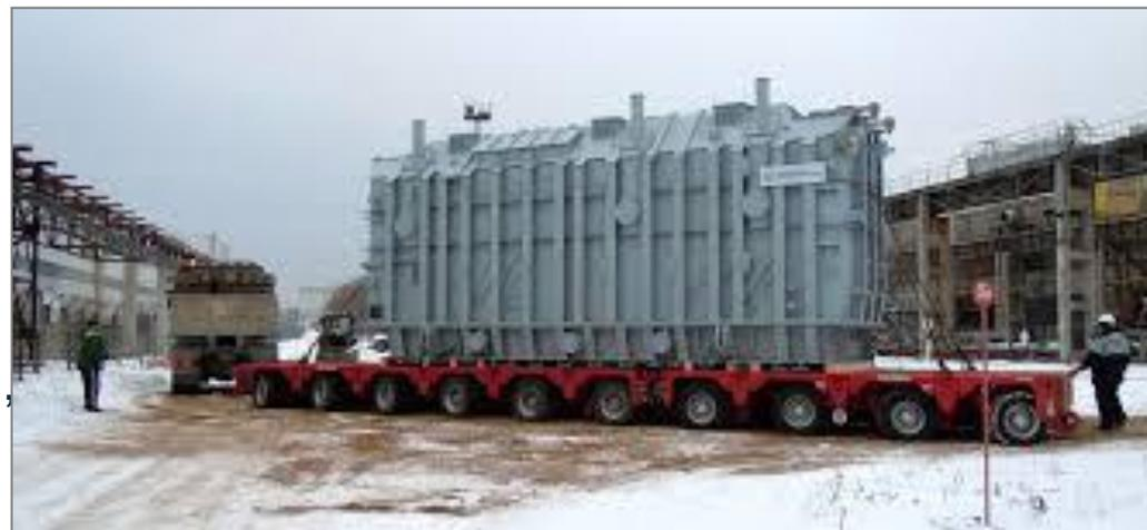
При этом, по мере необходимости, в соответствии с габаритами КТО, прицеп-платформы могут быть скомпонованы как по длине, так и по ширине (две платформы рядом).
