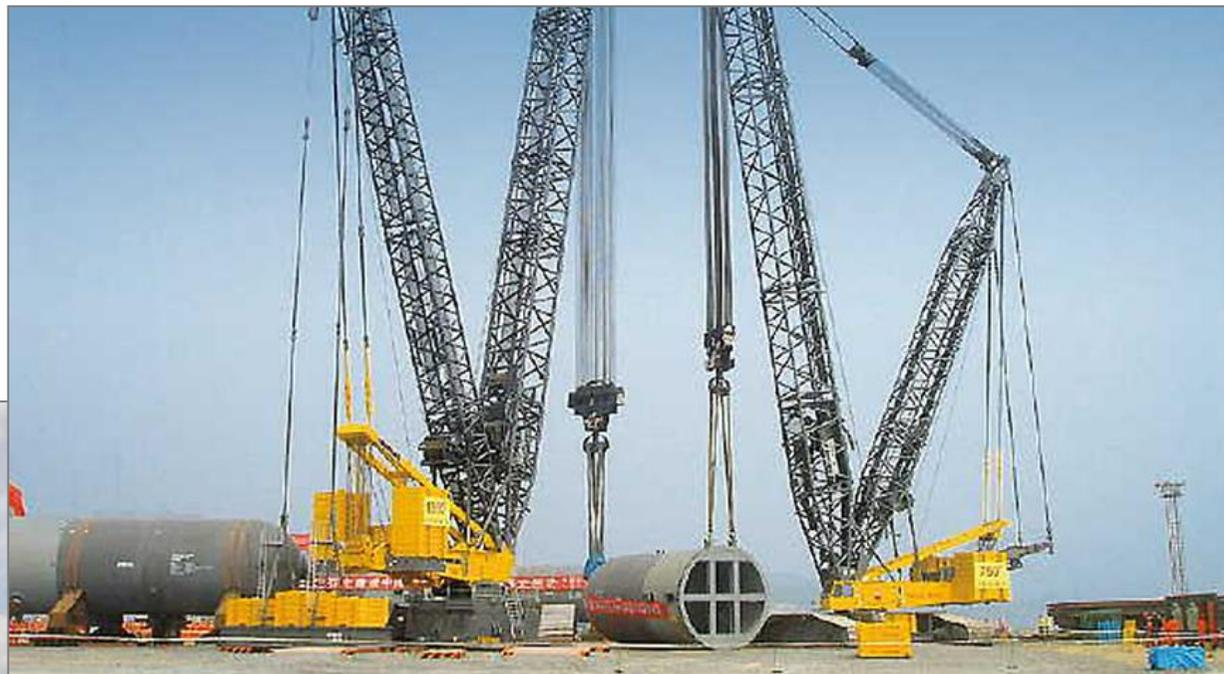
Подобные краны используются как на грузовых операциях с тяжеловесами, так и на монтажных работах, в том числе и при спаренной работе.
