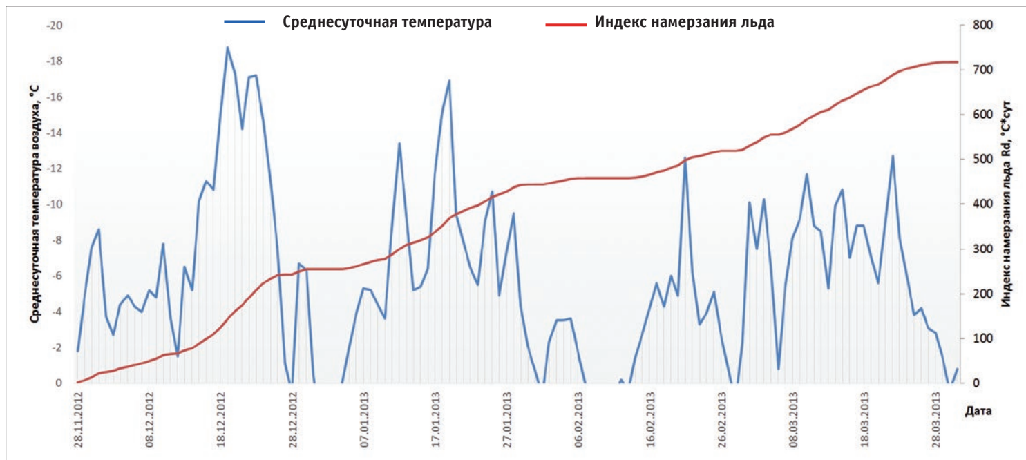
Рис. 1. Пример взаимосвязи между среднесуточными температурами воздуха и индексом намерзания льда
