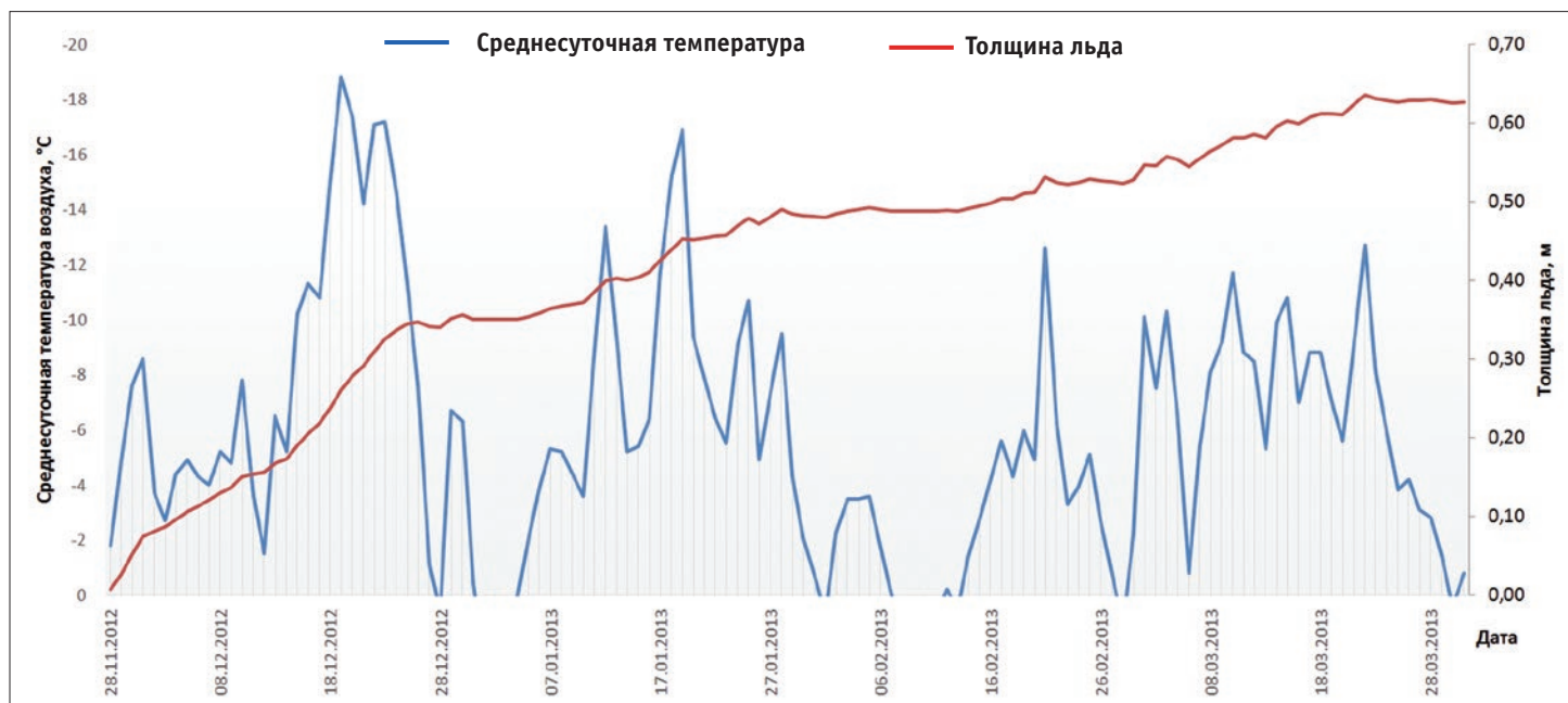
Рис. 2. Пример взаимосвязи между среднесуточными температурами воздуха и толщиной льда
