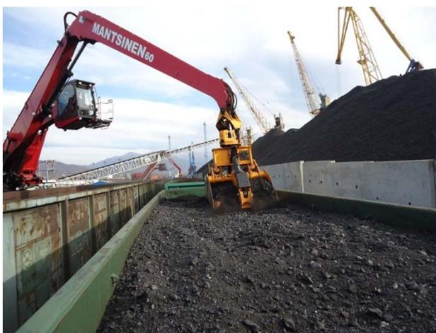
Эти качества чрезвычайно полезны для производительной, но щадящей грейферной выгрузки вагонов с навалочными грузами (по сравнению с канатным подвесом грейфера).
