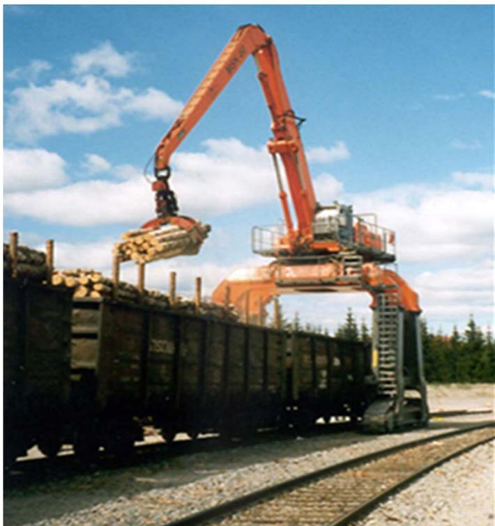
С ростом научно-технического прогресса в мировом машиностроении, в частности в области гидропривода, эти краны в последние два десятилетия прошли эволюцию от экскаватора к крану-манипулятору с точными движениями грузозахватного органа различного назначения.
