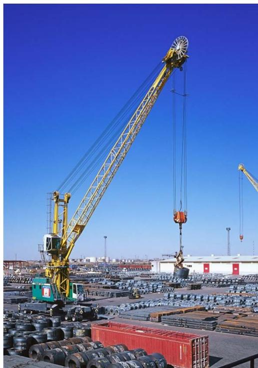
Эти краны обладают высокой *технологической функциональностью*, т.е. вылетом стрелы, грузоподъемностью, глубиной опускания и высотой подъема груза, скоростями для эффективной обработки трюмов практически любых сухогрузных судов на портовых терминалах. При этом они не лишены и некоторых недостатков:
