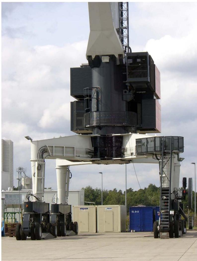
Кран удачно сочетает универсальность и технологичность традиционных порталных кранов, при этом обеспечивает приемлемую оперативность перемещения крана на другую колею. Кабельное электропитание несколько снижает его автономность, но в целом мобильность можно назвать оптимальной для портовых условий.
