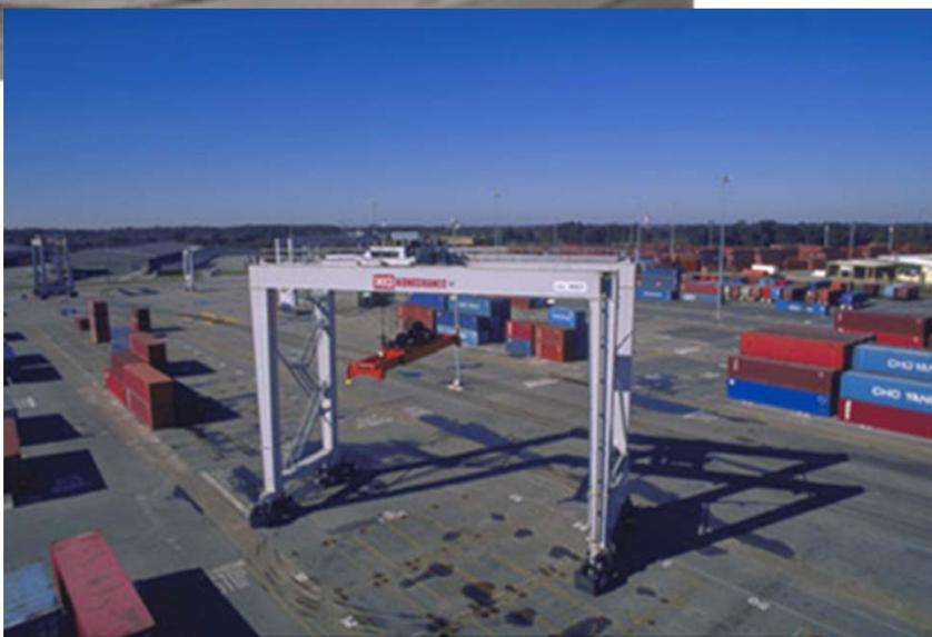
Характерным примером оптимизации мобильности является появление в последнее время мобильных контейнерных козловых кранов на пневмоходу (типа RTG) с кабельным электрическим питанием.
