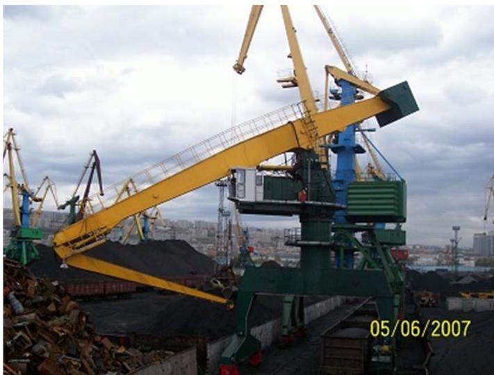
Так, в типовой линейке кранов–балансирующих фирмы ARDELТ (ранее *Kranbau Eberswalde, Германия*) стоят краны с грузоподъемностью до 25 т при вылете 38 м, скоростью подъема-опускания груза 100 м в минуту, поворота – 2 оборота в минуту.
