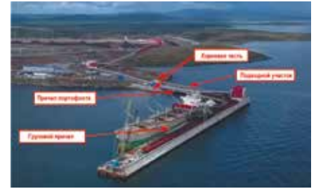
Рисунок 2 Схема расположения ГТС ТПК в бухте Мучке (фото МСТ)
