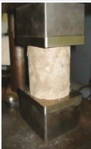
Рис. 6. Определение предела прочности на сжатие (слева) и растяжение (справа). Также был выполнен полевой контроль деформативности массива закрепленного грунта посредством штамповых испытаний
