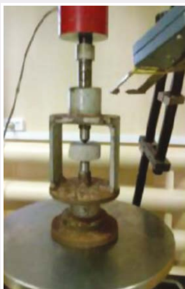
Рис. 6. Определение предела прочности на сжатие (слева) и растяжение (справа). Также был выполнен полевой контроль деформативности массива закрепленного грунта посредством штамповых испытаний
