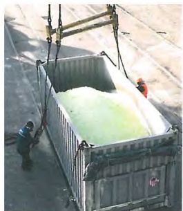
Застопка контейнера на причале
