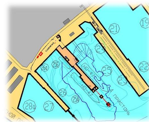
В конструктивном отношении представляет собой взаимозаанкеренную двухрядную конструкцию из шпунта (трубошпунта) засыпанную песком или щебнем.
