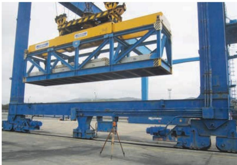
Рис. 3. Испытание путей мерными грузами
